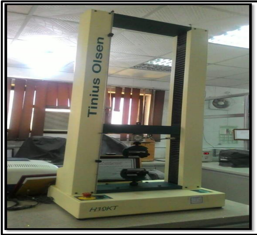
الشكل (3-9): صورة جهاز إختبار الشد.
