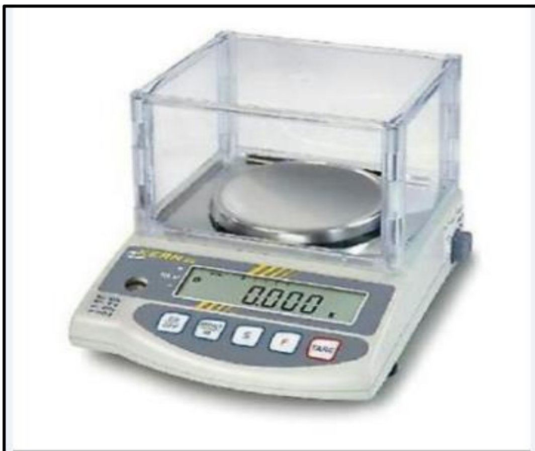
الشكل (3-3): صورة الميزان الالكتروني الحساس.
